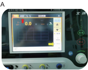
图 4 使用射频仪设置手动调节模式示意图 (A) 开启机器，进入待机工作界面，选择射频热凝模式（红色箭头所示），选择更多设定（黄色箭头所示）进入 (B) 界面；(B) 主控制参数默认为锁定模式，点击主控制参数按键进入 (C) 界面；(C) 此时显示主控制参数可调，即为手动调节模式开启，点击界面右上角返回即可。
