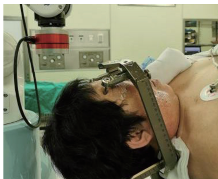
图 1 术中病人头部固定方式及与机器人机械臂位置关系
